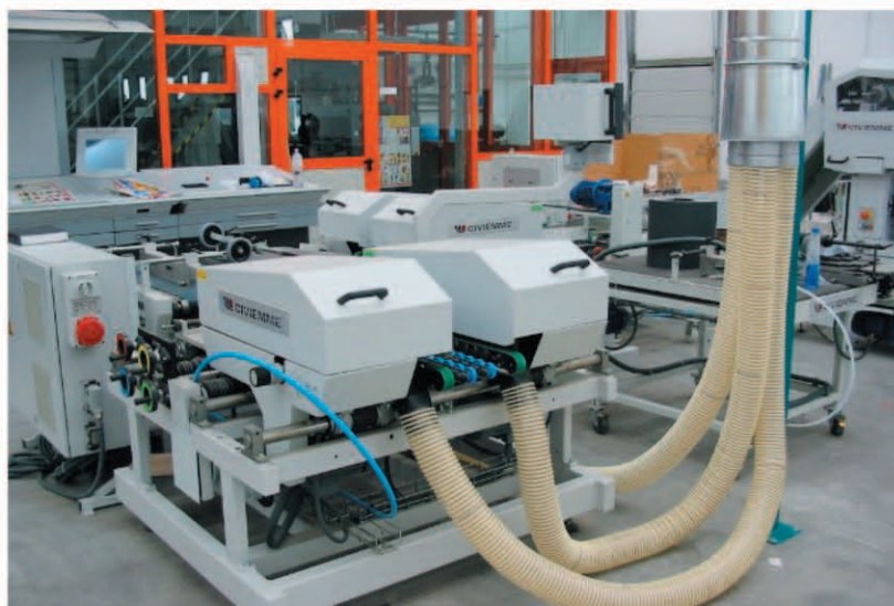
Particolare dell'impianto di aspirazione su una taglierina Civiemme.
